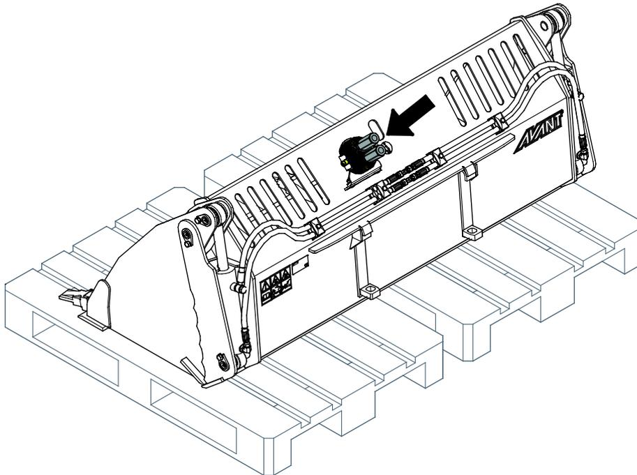
Reinigen Sie das Anbaugerät vor einer längeren Lagerung. Frischen Sie bei Bedarf den Lack auf, fetten Sie die Schmierstellen und ölen Sie die sichtbaren Teile der Hydraulikzylinderwellen, um Rostschäden zu vermeiden.
